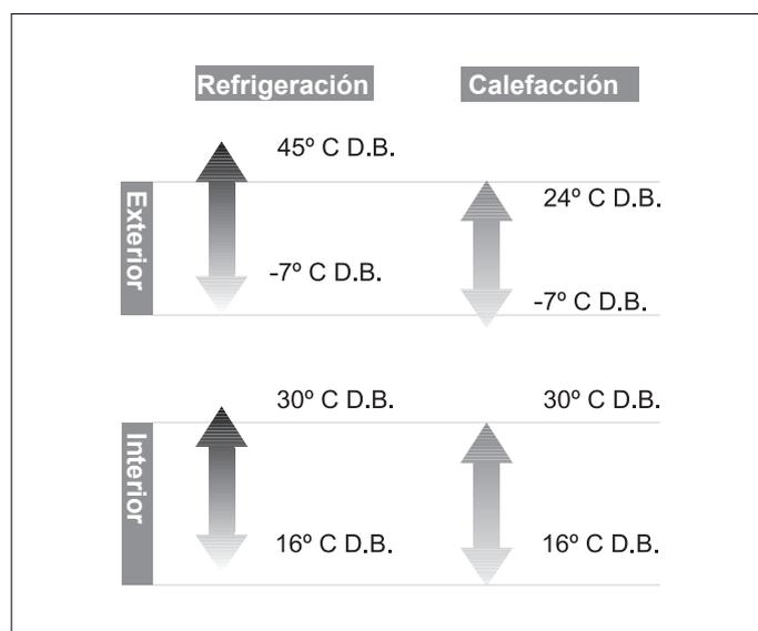
Fig. 2.1 Rangos de funcionamiento del aparato.
