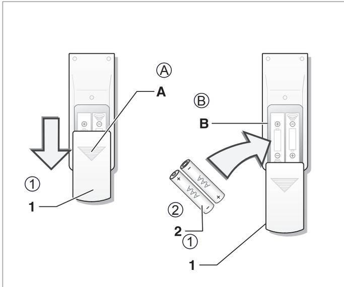
Figura 6.1 Instalación de las pilas del mando a distancia.
